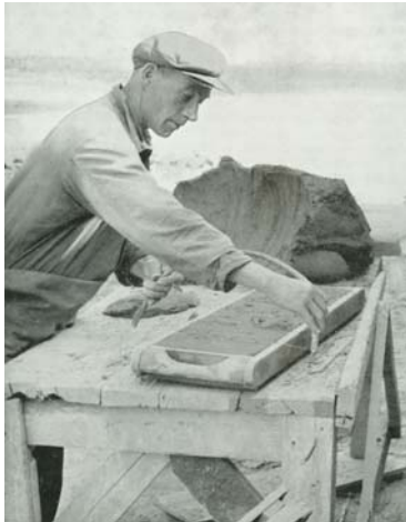
Het afstrijken van de klei bij handvorming (bron: Cageling en Preger, 1952).
